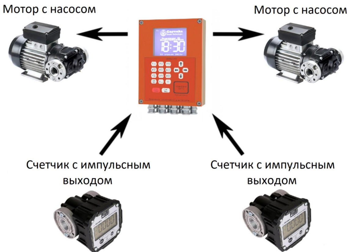
Рисунок 3: Конфигурация оборудования для двух постов
