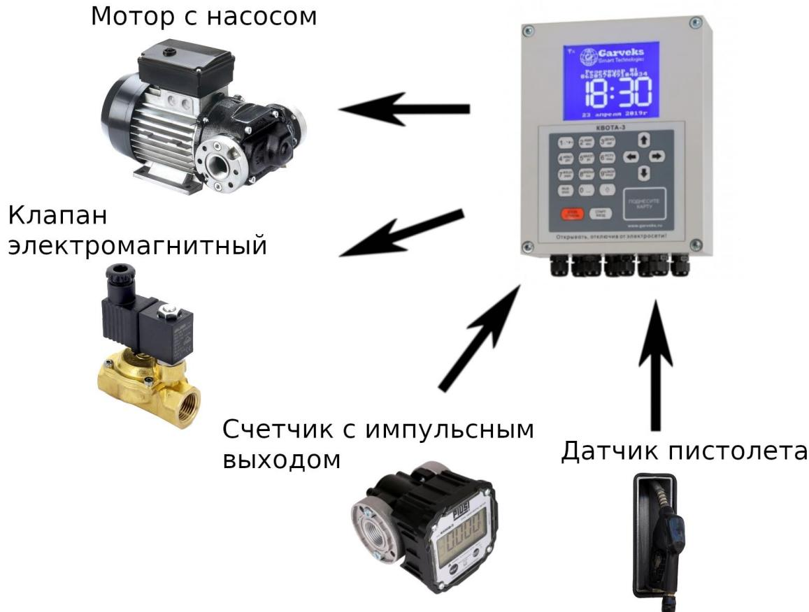
Рисунок 2: Конфигурация оборудования для одного поста
