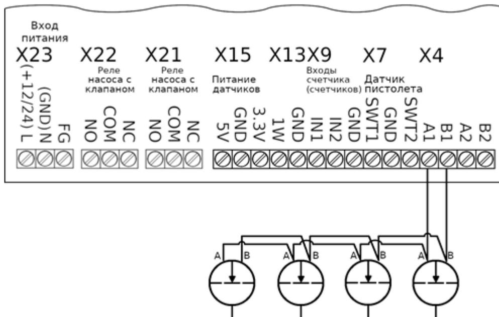
Рисунок 14: Схема подключения датчиков уровня
