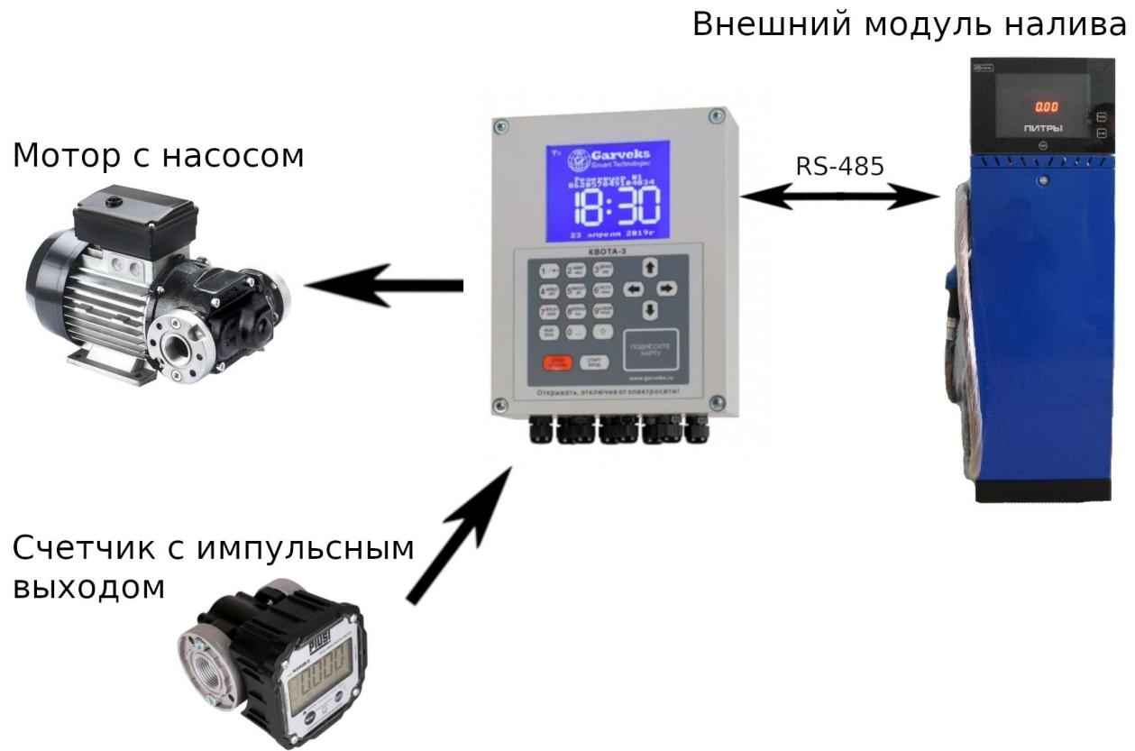
Рисунок 6: Комбинированный режим работы, два поста
