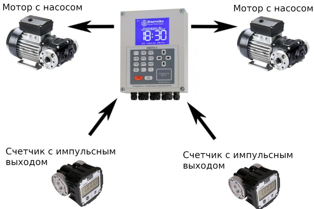
Рисунок 3: Конфигурация оборудования для двух постов
