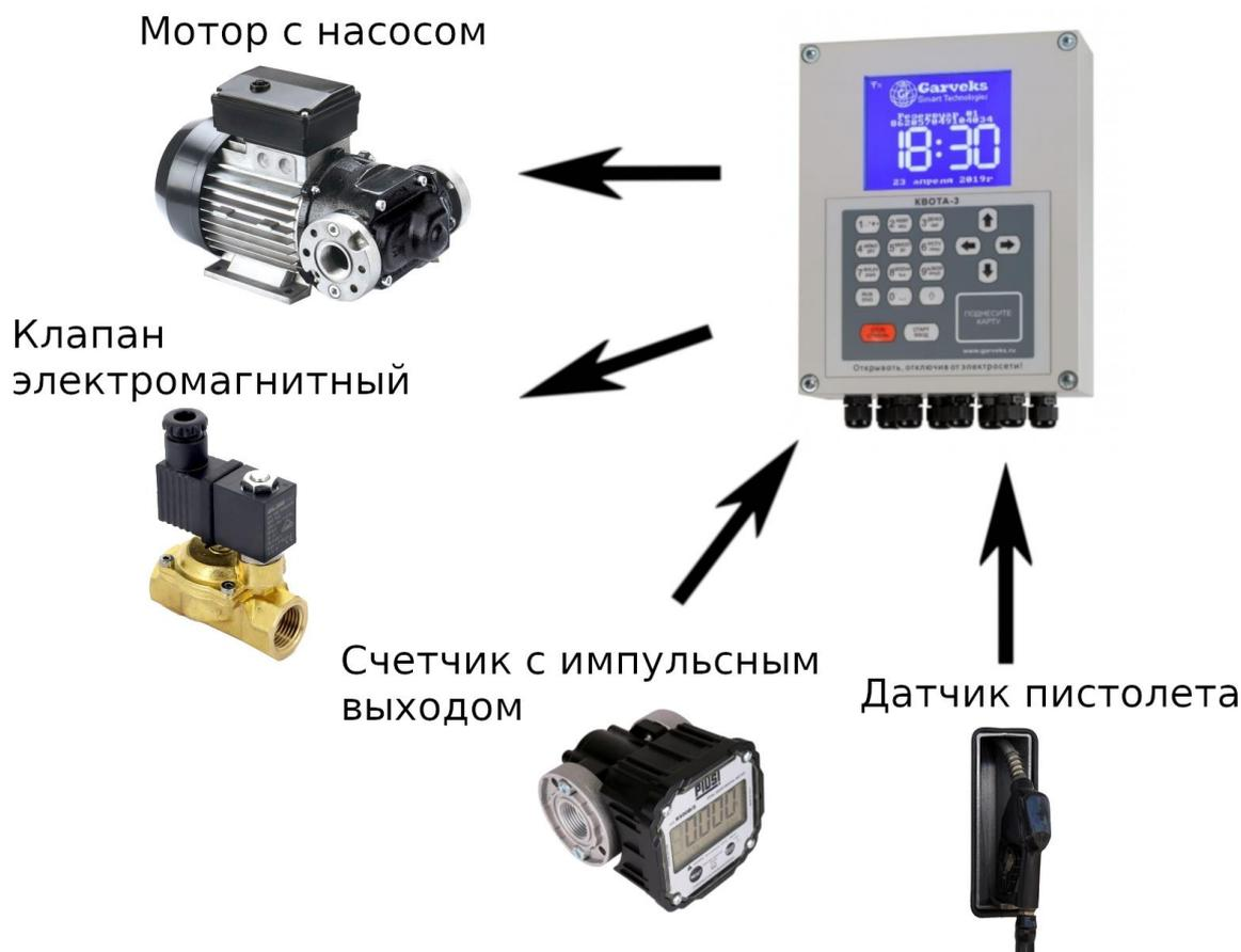
Рисунок 2: Конфигурация оборудования для одного поста
