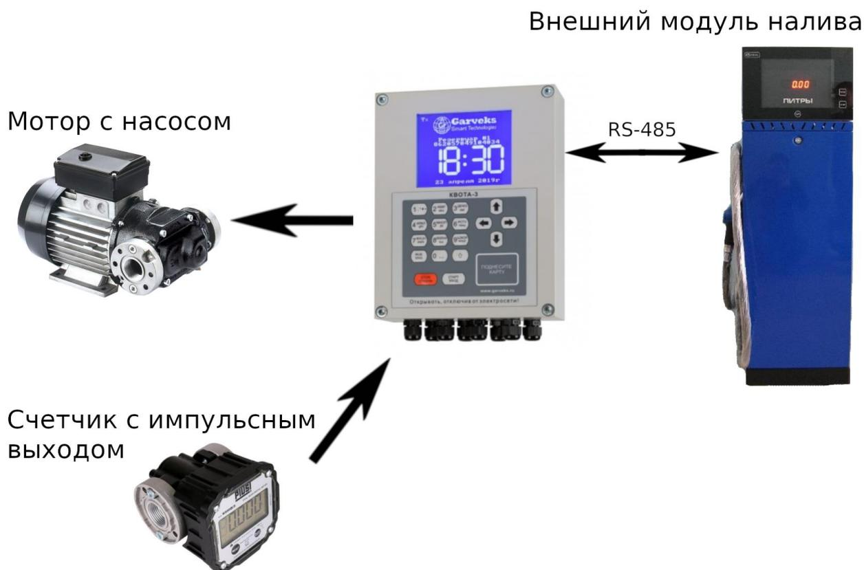
Рисунок 6: Комбинированный режим работы, два поста
