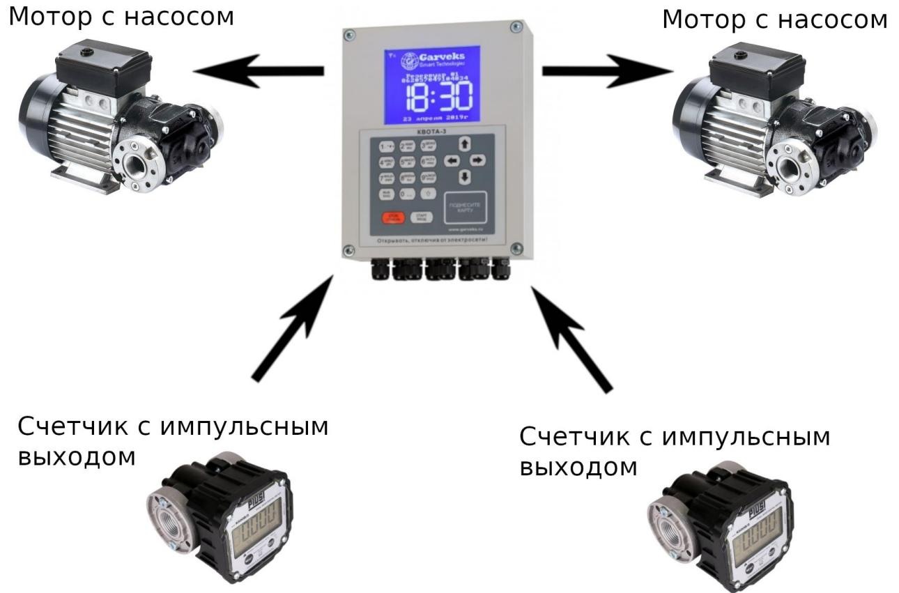
*Рисунок 3: Конфигурация оборудования для двух постов*
