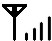
Есть сигнал. Пиктограмма отображает подключение к сети оператора и уровень сигнала, полученный из сети. Хотя в этом режиме контроллер и отображает уровень сигнала, это не значит, что открыто сетевое соединение. Также может не хватать пропускной способности сети.
