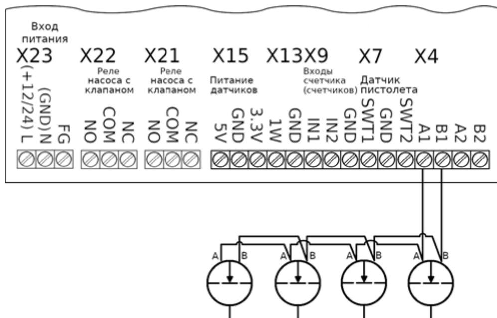
Рисунок 14: Схема подключения датчиков уровня
