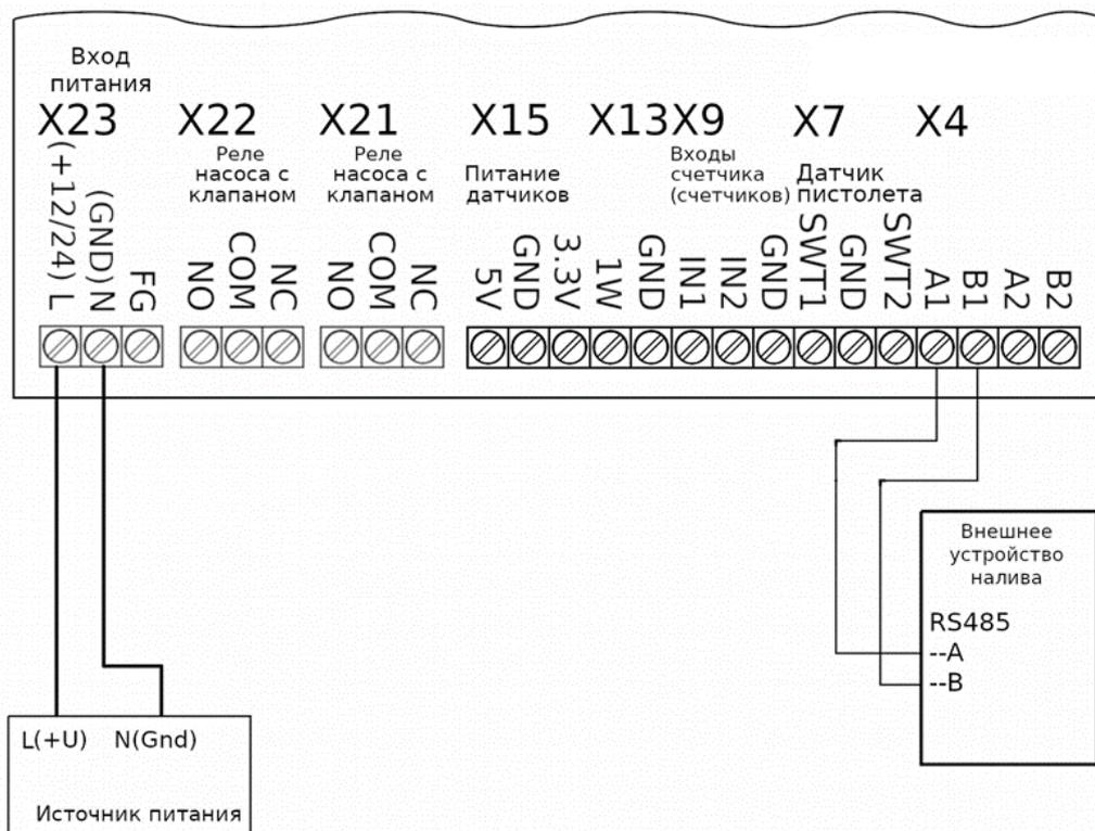
Рисунок 11: Схема подключения внешнего устройства выдачи в однопостовом режиме
