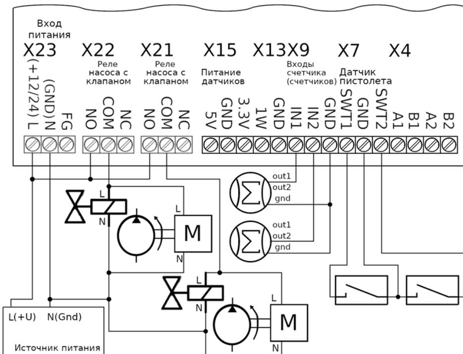
Рисунок 10: Схема подключения устройств в двухпостовом режиме
