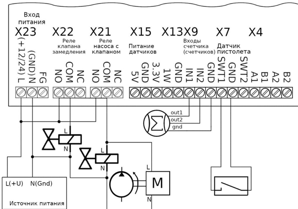
Рисунок 9: Схема подключения устройств в однопостовом режиме
